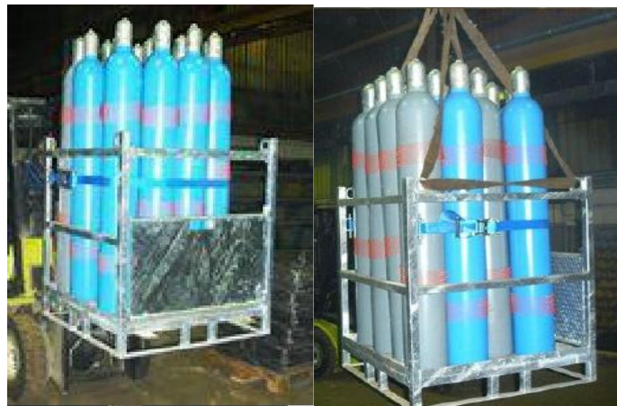
Slika 12. Transport pomoću viljuškara [10] Slika 13. Transport pomoću dizalice [10]
