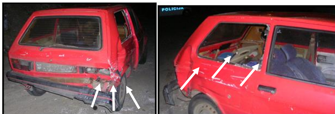
Slika 9. Oštećenja zadnjeg branika [3] Slika 10. Oštećenja zadnjeg desnog blatobrana i bočnog stakla [3]
