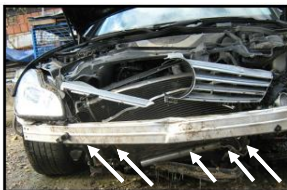
Slika 4. Prikaz oštećenja donjeg dijela hladnjaka rashlade tečnosti motora i hladnjaka klima [3]
