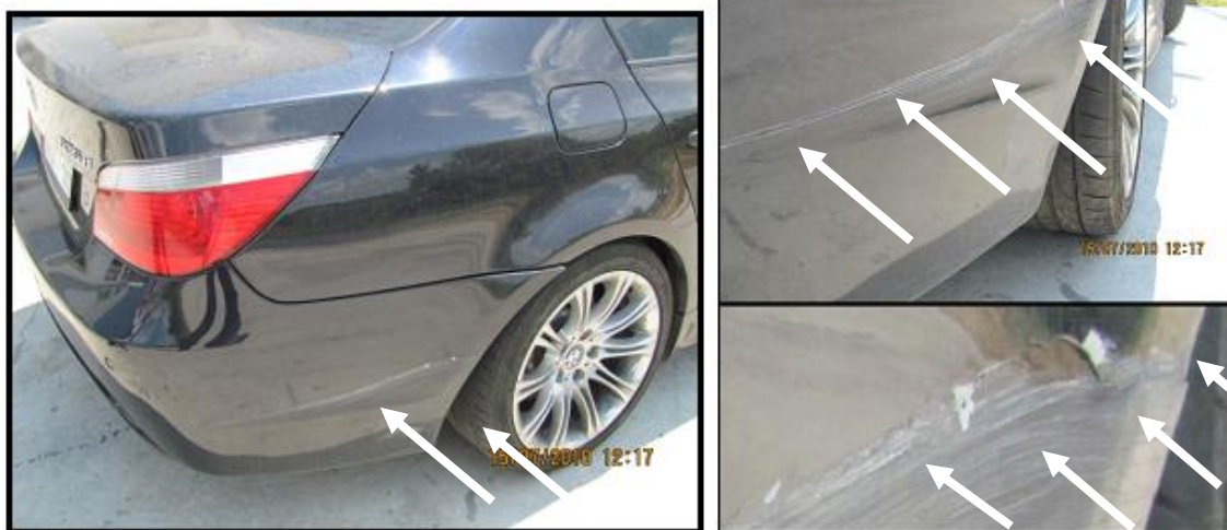
Slika 13. i Slika 14. Tragovi grebanja na zadnjem braniku i pukotina na desnom dijelu zadnjeg branika [3]
